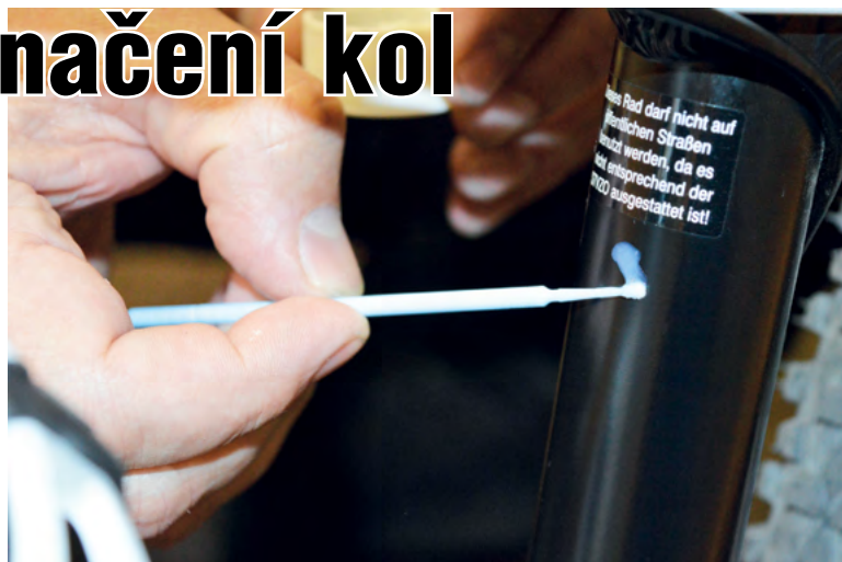
FORENZNÍ ZNAČENÍ: Mikrotečky zvyšují ochranu kol před odcizením.
